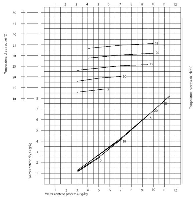
Výše uvedený diagram je platný pro podmínky množství regeneračního vzduchu cca 85 m<sup>3</sup>/h (což odpovídá 8A na ampérmetru) a nominální množství suchého vzduchu 400 m<sup>3</sup>/h.
