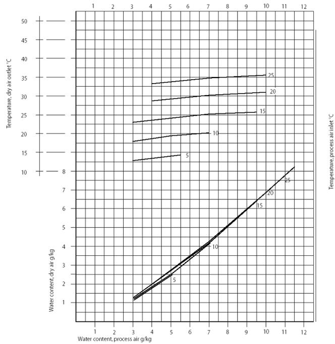
Výše uvedený diagram je platný pro podmínky množství regeneračního vzduchu cca 65 m<sup>3</sup>/h (což odpovídá 6A na ampérmetru) a nominální množství suchého vzduchu 240 m<sup>3</sup>/h.
